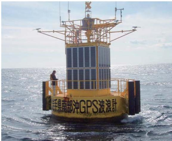
沖合に設置しているGPS波浪計（点検中）
