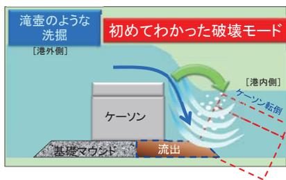
越流した津波は、ケーソンを支える基礎マウンドへ滝のように落下。石積みの基礎マウンドは流失し、支えを失ったケーソンは転倒。
