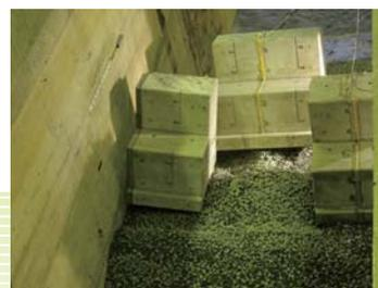
越流後のマウンド変形と倒壊
