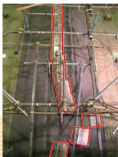
洗掘による防波堤倒壊再現
